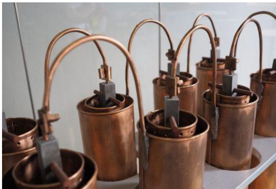
Figura 29: Associação de pilhas de Daniell para redes telegráficas. FONTE: https://www.ianvisits.co.uk/blog/2016/09/21/city-of-london-marks-150-years-of-transatlantic-telegraphs/ (Acesso em 8 maio 2021).
