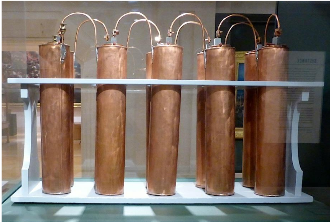
Figura 30: Associação de pilhas de Daniell para redes telegráficas.
