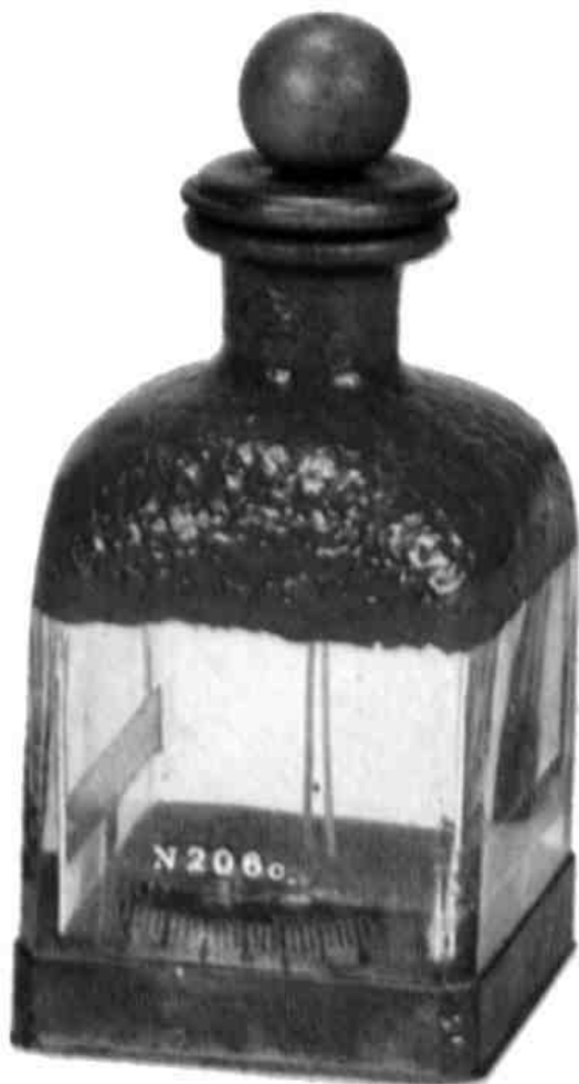
Figura 6. Para medir tensões elétricas, Volta desenvolveu um eletrômetro no qual, ao invés de folhas de ouro (utilizadas por Abraham Bennet), empregava duas hastes de palha, bem finas. O ângulo formado entre as palhas era aproximadamente proporcional à tensão elétrica
