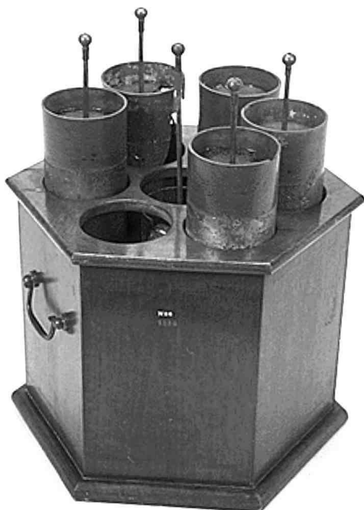
Figura 10. Na época em que Volta inventou sua pilha, dava-se o nome de bateria a certos conjuntos de garrafas de Leyden interligadas, capazes de armazenar grande quantidade de eletricidade. No seu artigo de 1800, Volta comparou os efeitos das pilhas com os choques produzidos por baterias
