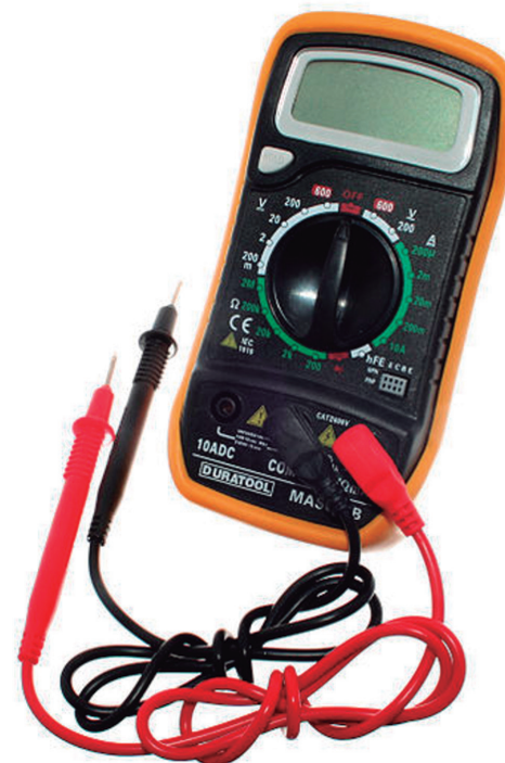
Figura 9: O multímetro portátil nos ajuda a descobrir o tipo de sistema elétrico de uma residência ou instalação comercial. Para isso, faça as medições das tensões entre fases e entre fase e neutro.
