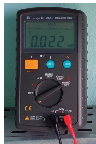
Figura 17: Megômetro, o instrumento utilizado para medir a resistência de isolamento.
