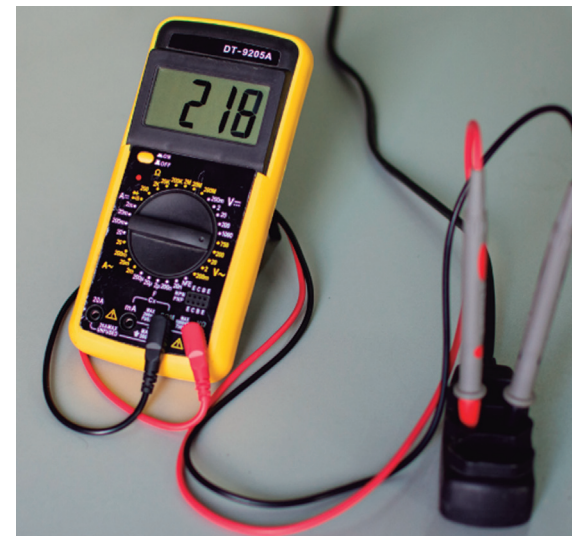
Figura 4: Para saber se uma tomada está funcionando, medimos a tensão existente no dispositivo.
