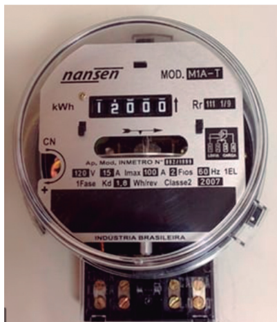
Figura 3: O relógio de luz, tecnicamente chamado de medidor de energia, mede a quantidade de energia consumida na sua casa.
