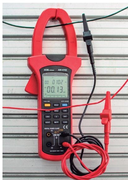
Figura 16: Alicates wattímetros podem vir com garras ou ponteiras que facilitam a medição sem o uso das mãos.
