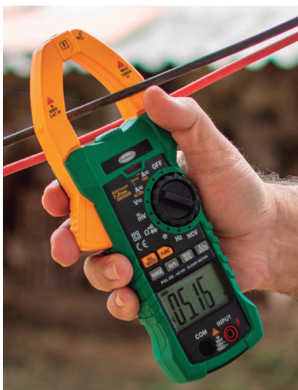
Figura 12: Alicate amperímetro e detalhe do local por passa o fio em que se deseja medir a eletricidade.
