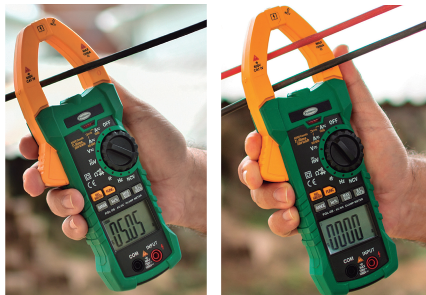
Figura 13: Na janela do alicate amperímetro, você deve passar apenas um condutor do circuito cuja eletricidade deseja medir.
