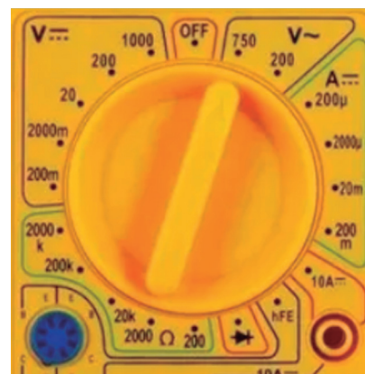
Figura 9: Detalhe da chave seletora de um alicate amperímetro.
