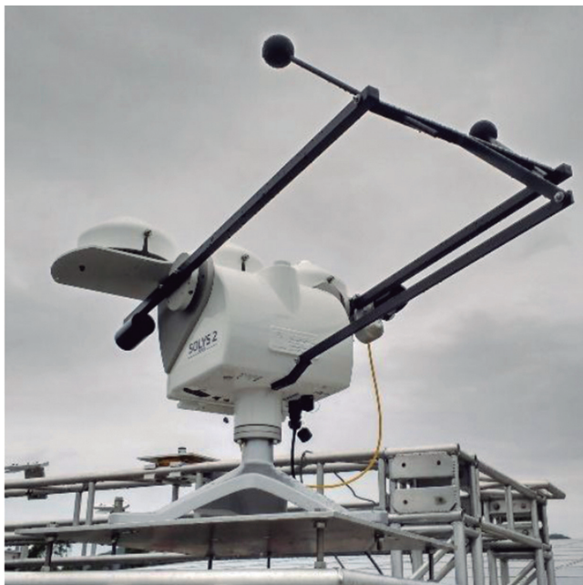
Figura 9: Rastreador solar. Observe as esferas de sombreamento usadas para medir a irradiação difusa.
