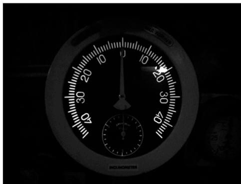
**Figura 12:** Inclinômetro analógico.
