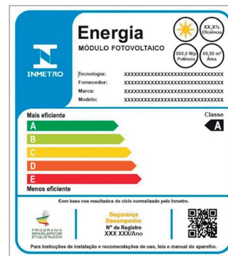
**Figura 3:** Selo Procel-Inmetro (presente na superfície posterior de um módulo fotovoltaico) e detalhe das informações.
