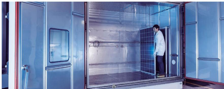
**Figura 1:** Câmara climatizada para testes de módulos fotovoltaicos sob várias condições climáticas simuladas em laboratório. Nesse caso, a temperatura varia entre  $-55^\circ\text{C}$  e  $+180^\circ\text{C}$ , por meio de um fluxo de ar vertical que possibilita gerar uma distribuição homogênea de calor dentro da câmara.
