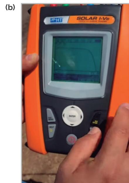
**Figura 6:** Curvas IV fornecidas pelo fabricante de um modelo específico de módulo fotovoltaico em sua folha de dados (a). Um equipamento capaz de traçar a curva IV do mesmo módulo para avaliar se o desempenho do equipamento está em conformidade com o esperado, quando conectado a uma carga qualquer (b). Esse teste deve observar determinadas condições: irradiação acima de 700 w/m<sup>2</sup>, céu ensolarado, claro, e sem presença de fumaça e tempo em condições aceitáveis para teste em campo.
