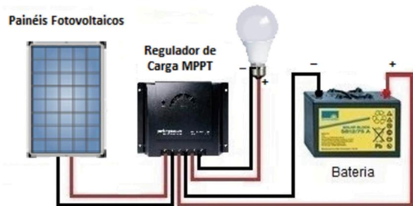
**Figuras 8:** Um regulador de carga (MPPT, *Maximum Power Point Tracking*, em inglês) entre o painel fotovoltaico e a bateria, com a função que seria a do diodo, minimizando a perda de potência da bateria.
