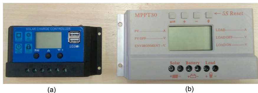
Figura 7: Controladores de carga PWM (a) e MPPT (b). O controlador MPPT é maior e mais caro que o controlador PWM, mas permite a operação do sistema com maior eficiência. Contudo, é necessário avaliar para cada caso se vale a pena o investimento maior para o ganho de energia que pode ser obtido.
