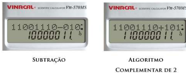
Figura 4.3 - Subtração de 11001110_2 - 01011010_2 : À esquerda operação de subtração; à direita aplicação do algoritmo "complementar de 2", na calculadora científica.
