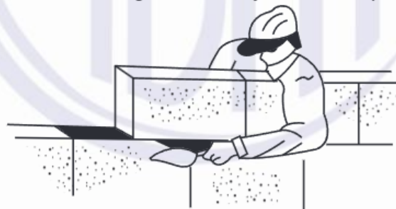
Figura 6 – Remoção do excesso de argamassa
