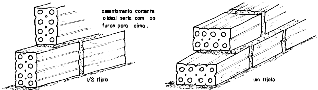
Figura 4.27 - Execução de alvenaria utilizando tijolos furados
