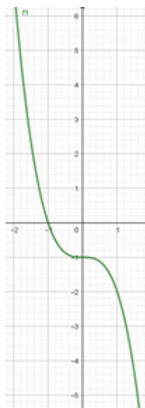
Figura 4.26 – Gráfico de x' por x dado por: x' = -x^3 - 1 (construído no Geogebra).
