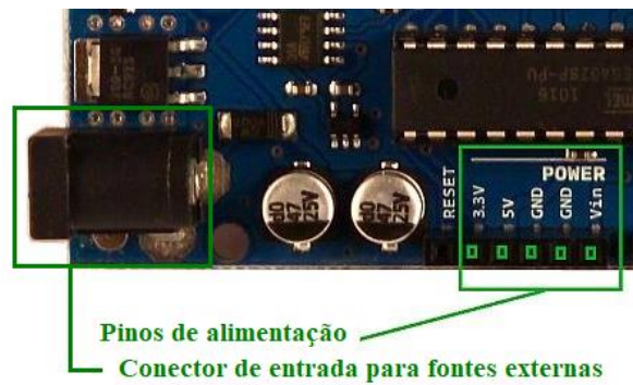
Figura 4: Pinos de alimentação e conector de entrada do Arduino. Fonte: Adaptado de http://www.eduino.com.br .
