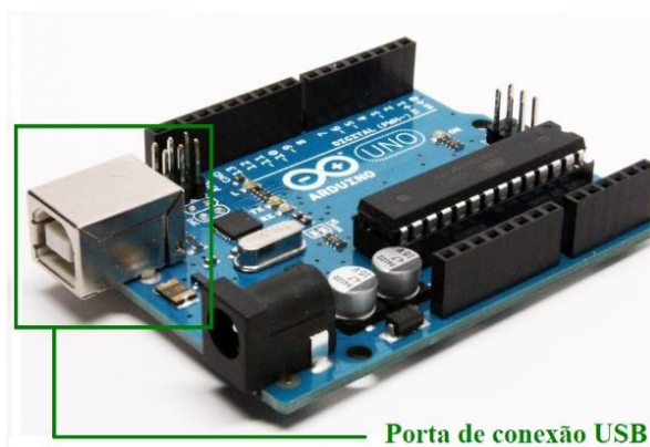
Figura 5: Conexão USB do Arduino. Adaptado de https://www.theengineeringprojects.com
