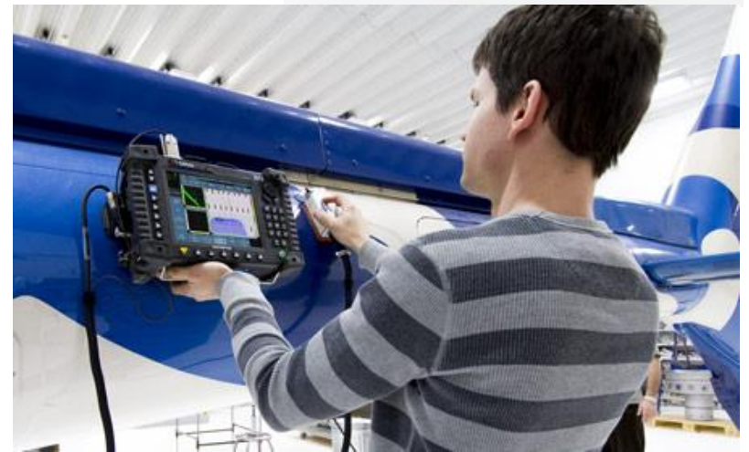
Ensaio não-destrutivo Olympus OmniScan MX
